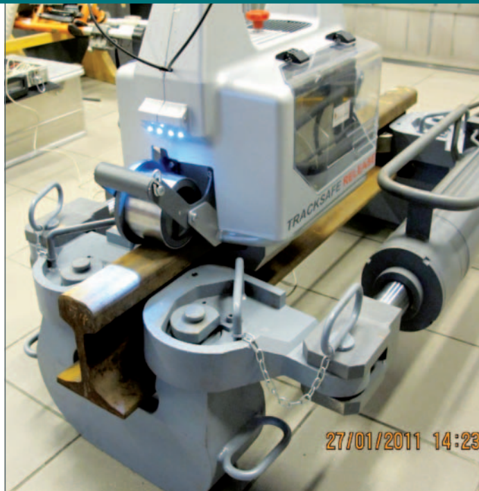
BILD 2: TRACKSAFERELEASE Werkskalibrierung: Durchführung einer Kalibrierung an ausgewählten Schienenproben. Mittels eines speziell angepassten Schienenziehgerätes werden definierte Zug- und Drucklaststufen über auf der Schiene angebrachte Spannungssensoren angefahren, gehalten und das Messgerät auf den Schienentyp einkalibriert
