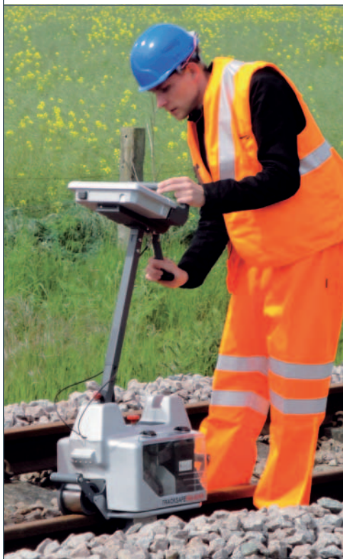
BILD 1: Zerstörungsfreie Neutraltemperaturvermessung mit TRACKSAFE RELEASE: Benjamin Dreilich, Elektro-Thermit Messtechnik & Service, bei Messarbeiten auf der Teststrecke von NetworkRail in High Marnham, Vereinigtes Königreich
